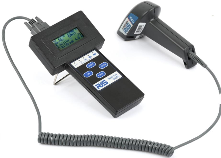
D4000是业界最灵活和性价比最高的ISO/ ANSI条码检测仪。这种独特的便携式条码检测仪D4000 具有两种不同的扫描头可以供连接，Auto-Optic扫描头和Laser（激光）扫描头，共有八种不同的光学配置，安装方便，基本上可以使用于各种场合的要求。使用可选的直接热印刷单元，可直接生成打印报告。
